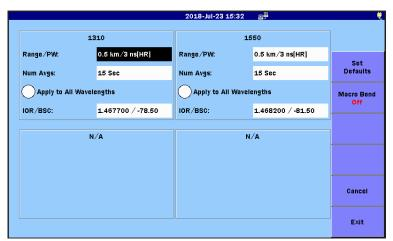
Figure 4.10.1-1 Test Parameters Screen
