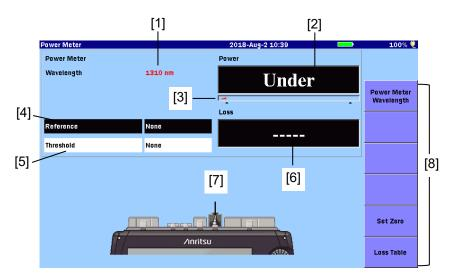
Figure 10.1.2-1 Power Meter Screen
